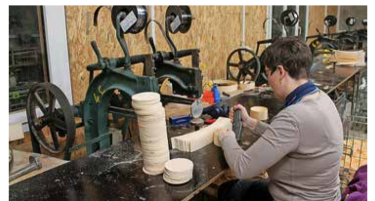
L'assemblage des boîtes demande de fixer manuellement deux agrafes avant que la machine prenne le relais.
